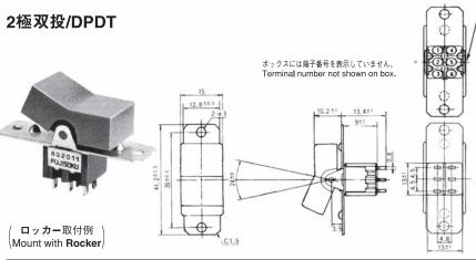
定格表示側 ng marking side スイッチ特性 Switching function 定格表示側から見て Viewed from rating marking side 形名 Part No. ★ 8Q2011-Z ON ON ▲ 8Q2011C-Z ★ 8Q2021 - Z ON OFF ON ▲ 8Q2021C-Z ★ 8Q2041 -- Z (ON) OFF (ON) ★ 8Q2051 - Z OFF (ON) ON ★ 8Q2061 - Z ON (ON) 接続端子 2-1 2 - 3Connecting 5-6 5-4 terminals
