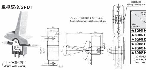
スイッチ特性 Switching function 定格表示側から見て Viewed from rating marking side 形名 Part No. ★8Q1011-Z ON ON ▲ 8Q1021-Z OFF ON ON ▲ 8Q1021C-Z (ON) OFF (ON) ★ 8Q1041-Z ▲ 8Q1051-Z ON OFF (ON) ▲ 8Q1061-Z ON (ON) 接続端子 2-3 2-1 Connecting terminals
