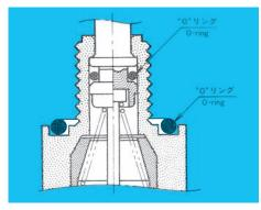
ウォータープルーフプッシュスイッチは水中で使用するのではなく、水滴などを防止するためのパネルシール用スイッチです。二重の"O"リングは防水性ばかりでなく塵埃の浸入防止にも役立ちます。
